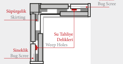
2-c Nolu Eşiksiz Alt Ray Detayı Nr. 2-c Details of Lower Rail with no Windowsill
